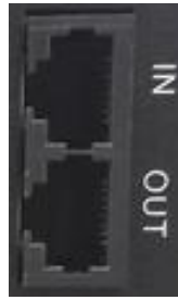
Рисунок 1.7 – Порты защиты телефонной линии в СБП
