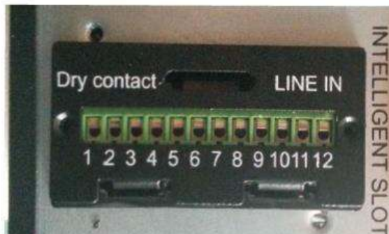
Рисунок 15 - Вид передней панели релейной карты
