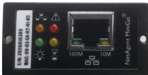
Рисунок 12 Общий вид передней панели карты SNMP Стандартная
