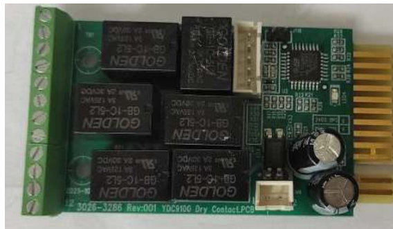
Рисунок 14 - Общий вид релейной карты
