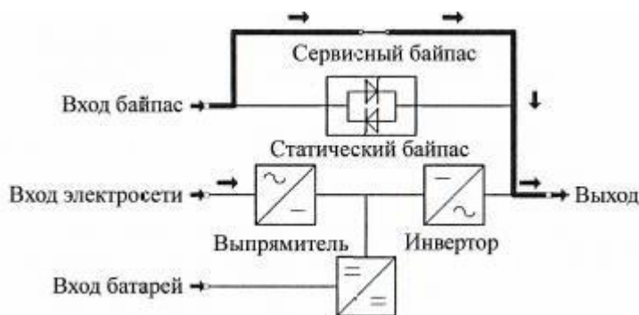
Рисунок 12 – Режим технического обслуживания (сервисный байпас)
